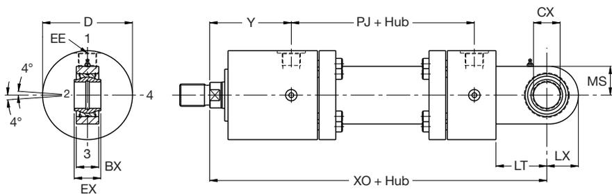
**Abmessungen – MP3 und MP5** Vgl. Abmessungen Kolbenstangenende auf Seite 9
