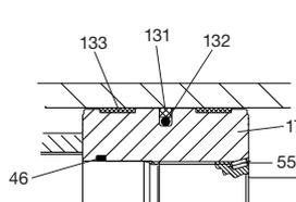
**Reibungsarme Büchse und Dichtungen**
