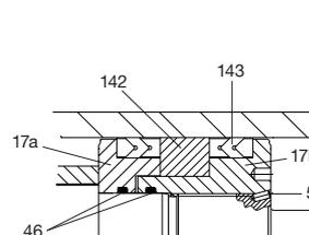
**Dachmanschettenbüchse und -dichtungen**
