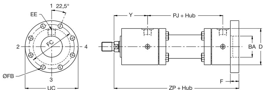
**Abmessungen – MF3 und MF4** Vgl. Abmessungen Kolbenstangenende auf Seite 9
