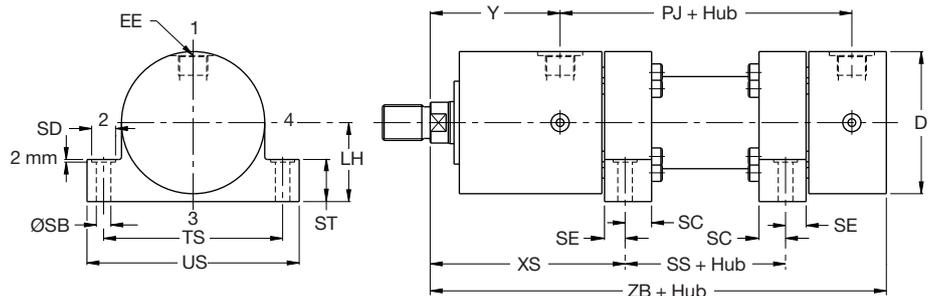
**Hinweis:** Die Befestigungsart MS2 ist bei einem Verhältnis Bohrung/Hub über 2 : 1 und Betriebsdrücken über 160 bar nicht empfehlenswert, d.h. wenn der Bohrungsdurchmesser größer dem doppelten Hub ist.
