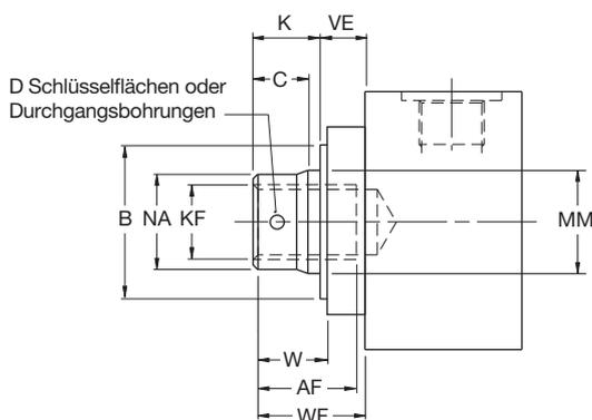
**Abmessungen Kolbenstangenende** Vgl. Befestigungsinformationen auf den Seiten 5-8
