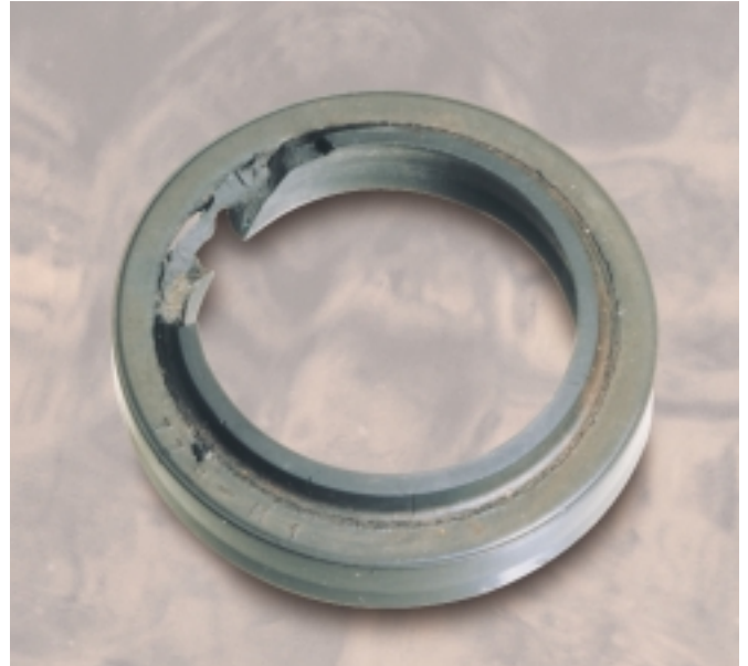
Abb. 9 Der Kolbenstangen-Schmutzabstreifer kann extrudieren (oben), die primäre Kolbenstangendichtung sieht jedoch unversehrt aus (rechts), so daß bei der hydrostatischen Prüfung keine Leckage auftritt.
