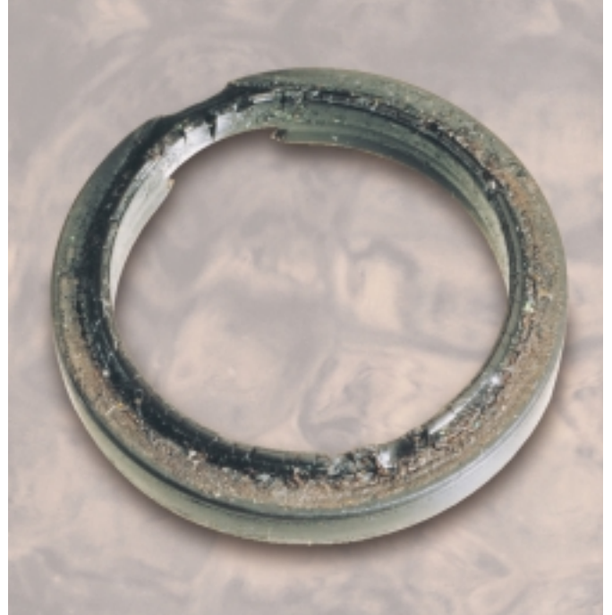
Abb. 6 Die rissige Außendichtlippe dieses Schmutzabstreifers weist Schäden auf, die durch zu hohe Temperaturen verursacht worden sind.
