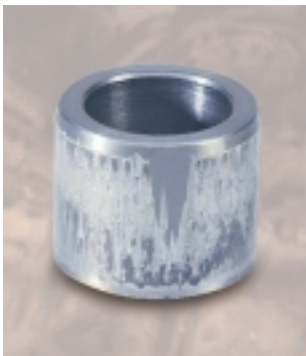
Abb. 4 Die Oberfläche dieser Dämpfungsbüchse wurde durch Teilchenverunreinigung beschädigt, was zu einem Verlust des Dämpfungseffektes führt.
