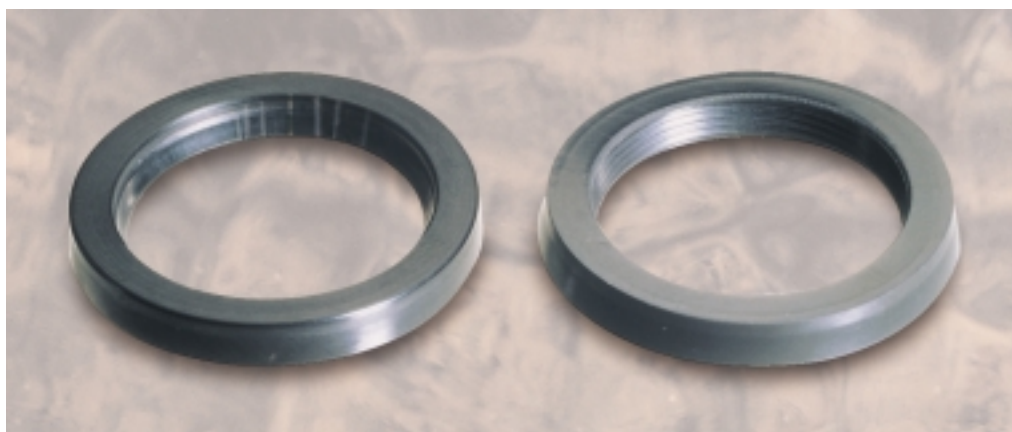
Abb. 3 Schäden durch Verunreinigung werden bei dieser Kolbenstangendichtung sichtbar, bei der die Dichtlippen völlig abgenutzt sind. Zum Vergleich: rechts eine neue Dichtung.
